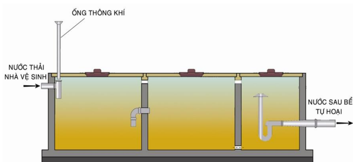
Hình 3. 5: Mô hình bể tự hoại ba ngăn
