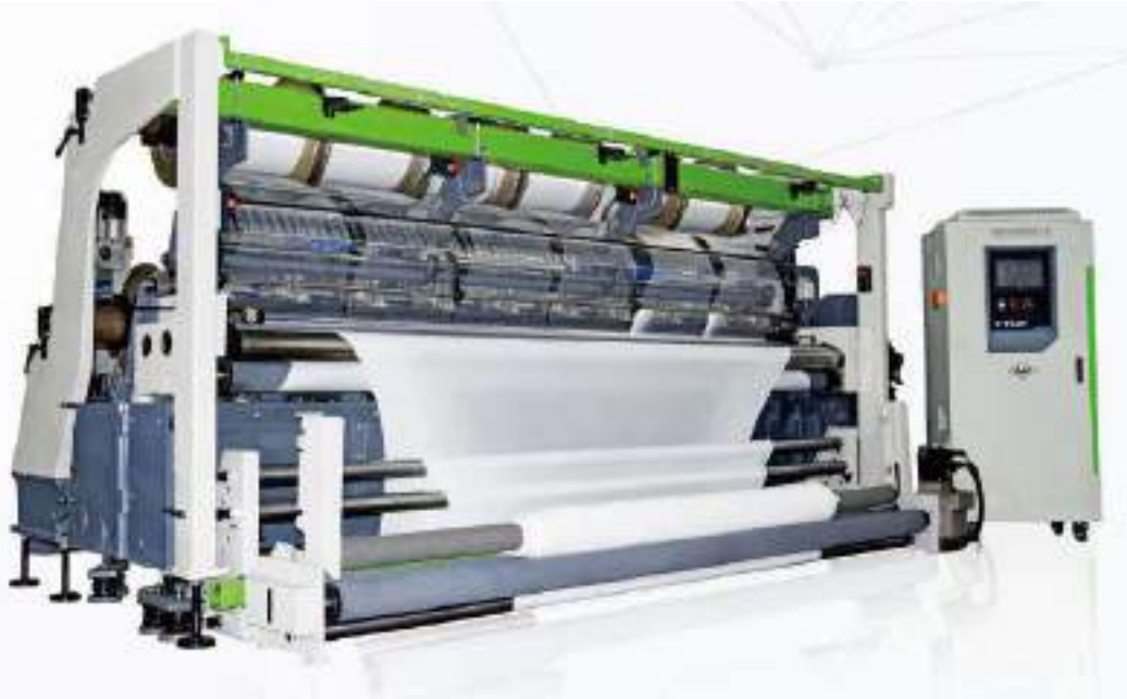
Hình 1.6. Hình ảnh minh họa máy dệt kim đơn dọc tại Dự án
