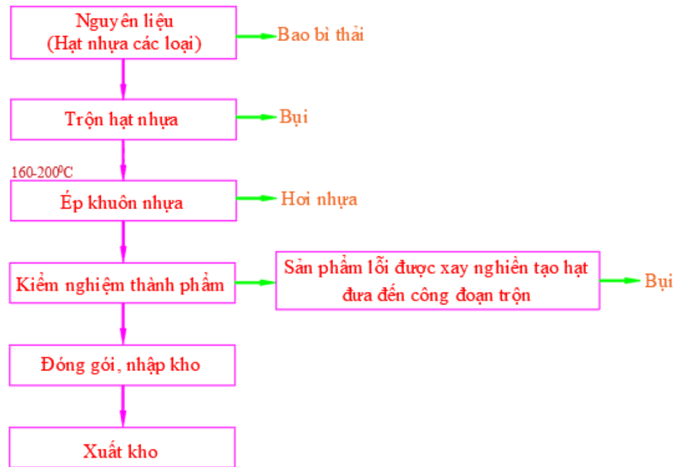
Hình 1.12. Sơ đồ quy trình lõi nhựa
