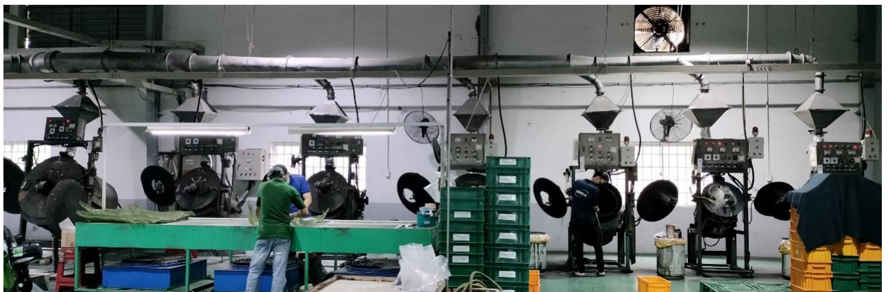
Hình 37. Hình ảnh sơ đồ thu gom khí thải từ công đoạn phun sơn tự động nhà xưởng 1
